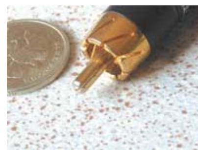
Штекер RCA. Байонетный фиксатор – гарантия надежного контакта
