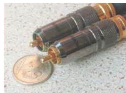
Штекер RCA. Выдвижная упругая обойма позволяет устранить помехи при подключении кабеля
