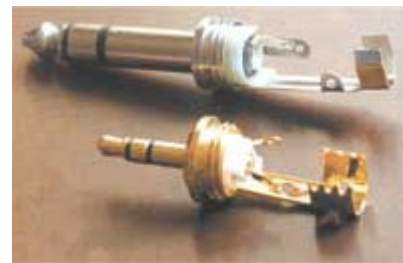
Профессиональные разъемы оснащены кабельными фиксаторами
