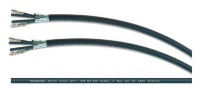
Серия мультикоров Van Damme SeaCat состоит из двух версий кабеля - 4-проводникового Cat5E с экранированными одножильными проводниками и 8-проводникового Cat5E, объединенного с 4 многомодовыми волокнами ОМЗ для потенциального использования в сети Ethernet 10G. Как и в других мультикорах серии SeaCat, эти кабели обладают LSZH (Low Smoke Zero Halogen) изоляцией, благодаря огнестойкости которой они идеальны для
