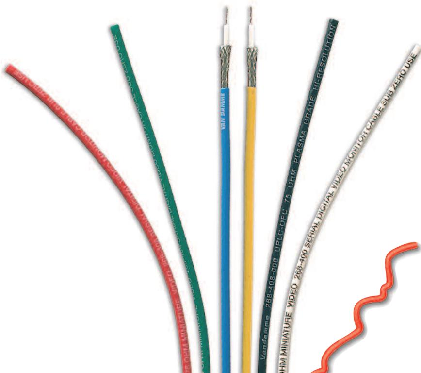
Van Damme миниатюрный 75 Ом Plasma Grade видео коаксиальный кабель был разработан для высококачественной передачи сигналов по кабелям с малым внешним диаметром. Серия этих кабелей соответствует стандарту RG179 и доступна в 5 различных цветах для удобства идентификации различных сигналов при инсталляции.
