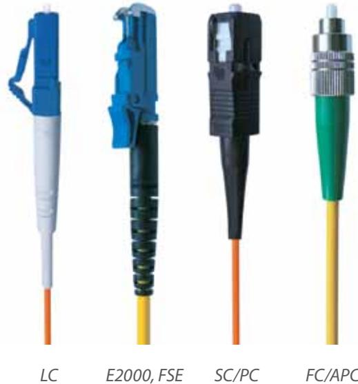
**Оптические соединители** - вилки служат для коммутации активного сетевого и каналаобразующего оборудования, кроссов и внутрикросовых соединений. Стандартные одномодовые (9.5/125) и многомодовые (50/125, 62.5/125) вилки (patchcord) и полувилики (pigtail) изготавливаются на волокне в буферном покрытии диаметром 0,9мм, на одножильном кабеле диаметром 2 мм, на двужильном (дуплексном) кабеле.
