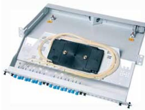
— Кросс состоит из неподвижного 19"; корпуса, предназначенного для укладки кабельной петли, и выдвижной легкоубираемой поворотной монтажной панели с установленными на ней оптическими модулями и сплайс-пластины.
