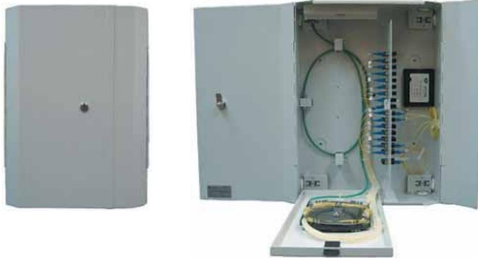
Оптический кросс, с дверцами и замком, обеспечивающим защиту от несанкционированного доступа. Рассчитан на 48 розеточных портов всех стандартов. Кабельный ввод расположен снизу, сверху и с боковых сторон корпуса кросса. Кабель фиксируется в заглушке - сальник HP-25, крепится стяжками. Предусмотрен узел крепления силового элемента. Сплайс-кассета, для разводки и укладки волокна установлена на откидной панели. Предусмотрено место для установки сплиттера и место для укладки запаса кабеля.
