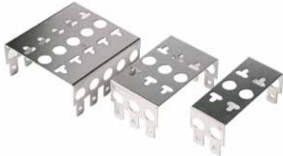
Применяются для открытого монтажа плинтов фирмы "Krone" и их аналогов в телефонных кроссовых сооружениях любой емкости. Открытый монтаж не требует никаких конструктивных элементов кроме собственно монтажных хомутов, которые представляют собой П-образные скобы изготовленные из углеродистой стали с никелированной поверхностью. На боковых поверхностях хомутов имеются отверстия для ввода кабеля. Ширина шага – 22,5 мм.
